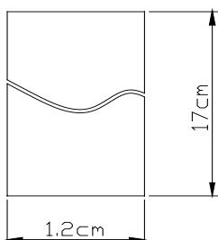
**9.5 THE SHAPE AND DIMENSION OF PACKING CARTON.** 包装盒的外型及尺寸
